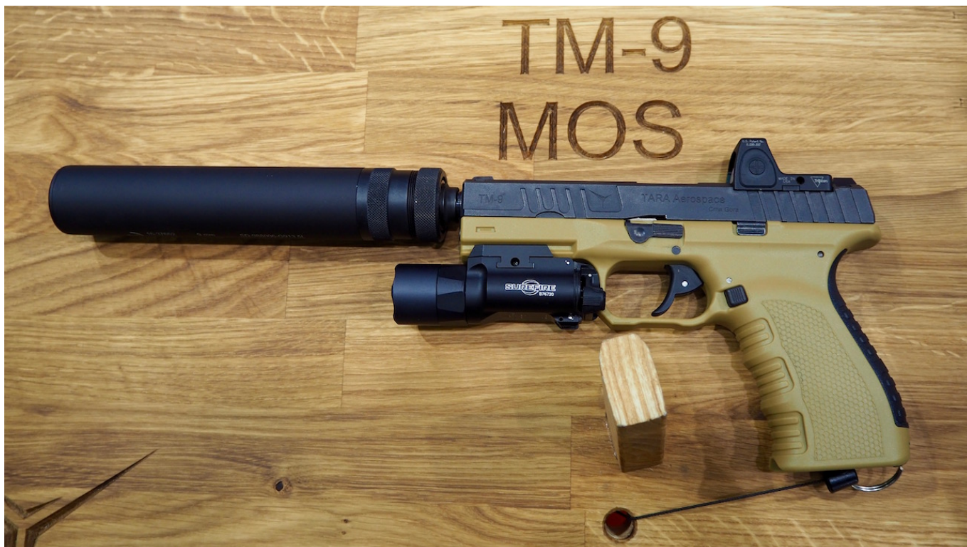
Pistolet Tara TM-9 z tłumikiem dźwięku i celownikiem kolimatorowym. Fot. J.Sabak
